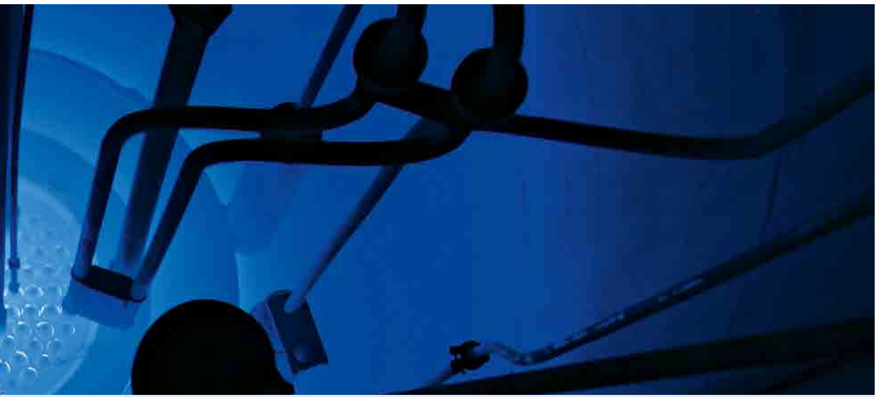
Pulsbetrieb am TRIGA Mainz mit der charakteristischen bläulichen Tscherenkow-Strahlung (Ausschnitt).
